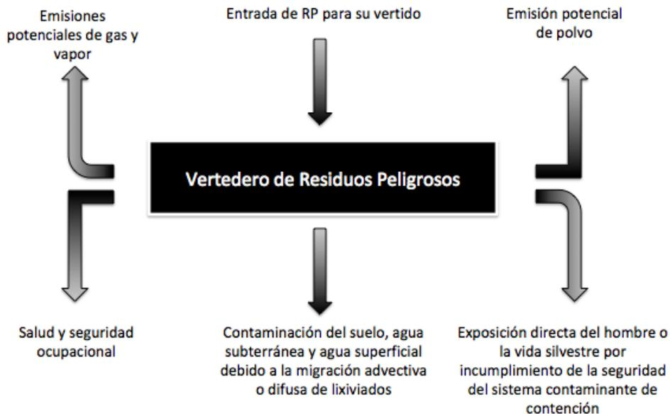
**Figura 1. Diagrama esquemático de posibles vías de liberación de sustancias en un vertedero de RP.**
