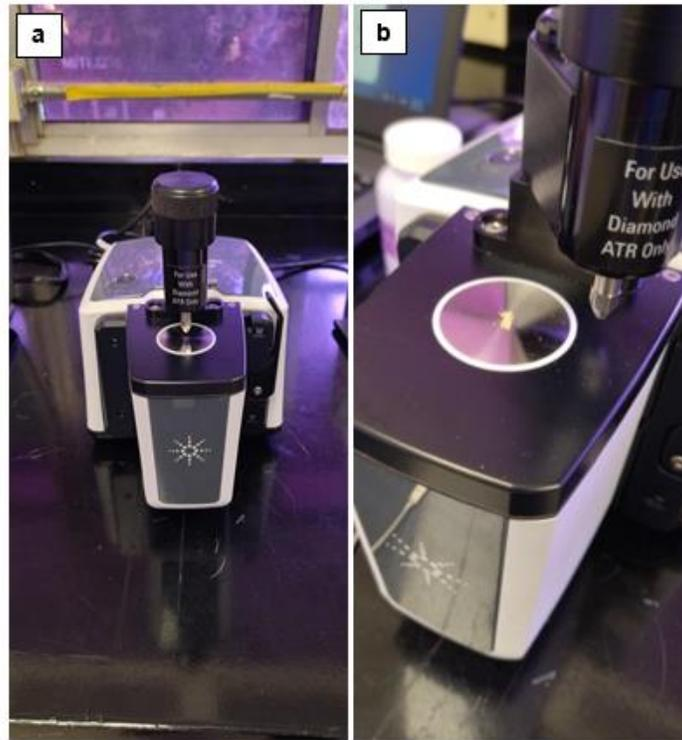
**Figura 26.** Espectroscopia de infrarrojo con trasformada de fourier, a) Con el accesorio de reflexión total atenuada (ATR-FTIR), b) Muestra de subproducto de madera previo a análisis.
