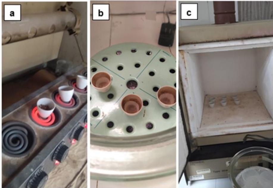
**Figura 13.** Imágenes del procedimiento de la determinación de cenizas a) Muestras de subproducto madera residuo de madera en crisoles cerámicos pre incinerados en parrilla de resistencia eléctrica, b) Muestras pre incineradas en deshumidificador, c) Calcinación de las muestras en la mufla.
