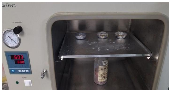
**Figura 12.** Determinación de humedad del subproducto de madera en contenedores de aluminio a 60°C.
