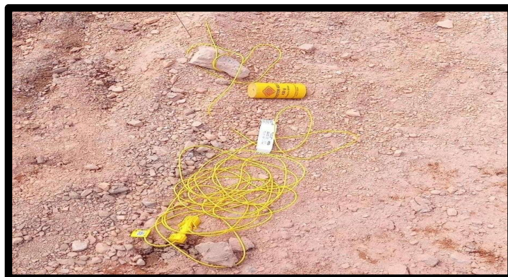
Figura 26.- Booster de Pentolita con su cordón fulminante de retardo de 17 milisegundos.
