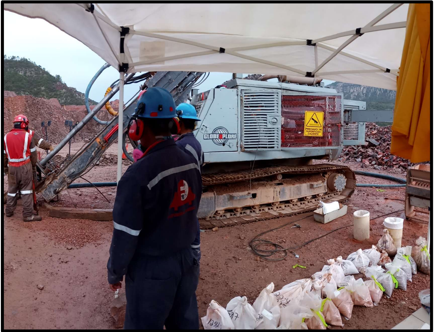
Figura 35.- Maquina de barrenacion tipo RC, perforistas y ayudantes de geología enTajo Reyna de Plata 1, banco 2060.
