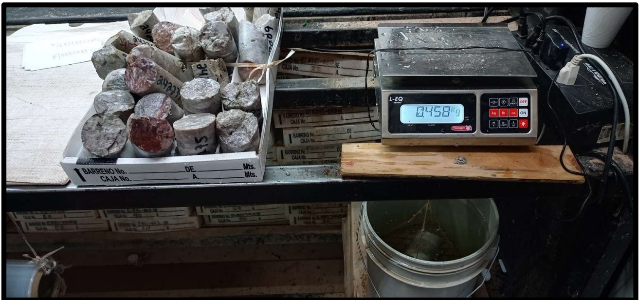
Figura 34.- Báscula, núcleos y cubeta con agua para cálculo de densidades en bodega de núcleos.
