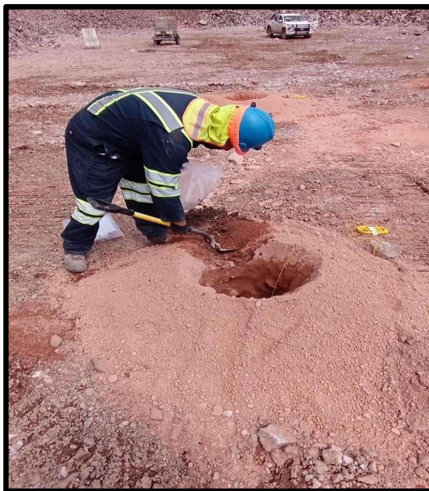
Figura 28.- Muestreo de Barrenos de Producción.
