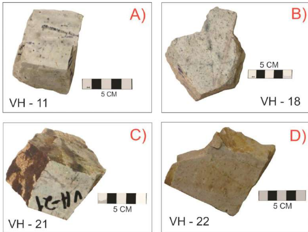
Figura II.25. Muestras de mano de Intrusivo Granítico Porfídico, nótese los distintos tipos de alteraciones que presenta y se sobreponen. A) vetas de cuarzo – turmalina, B) clorita – hematita – sericita, D) epidota – sericita – hematita.
