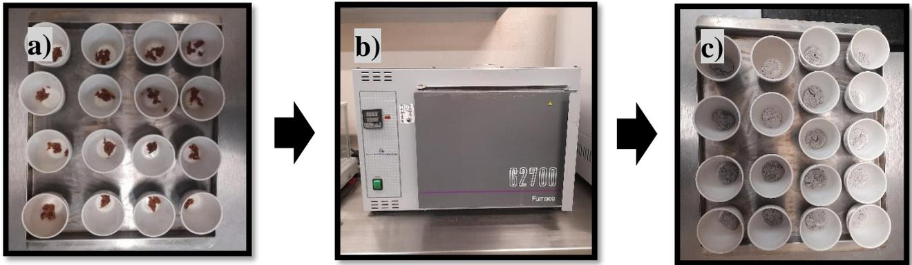
**Figura 9.** Proceso de incineración: a) muestras de músculo seco, b) mufla (F62700-Thermolyne Furnace), c) ceniza de las muestras incineradas.
