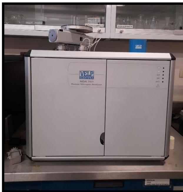
**Figura 11.** Analizador de nitrógeno DUMAS (Modelo 702 NDA).
