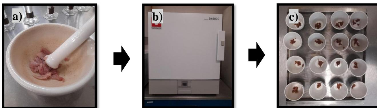
**Figura 8.** Proceso de secado: a) músculo de tilapia b) horno (IC602 - Yamato Scientific) c) crisoles con muestras secas.
